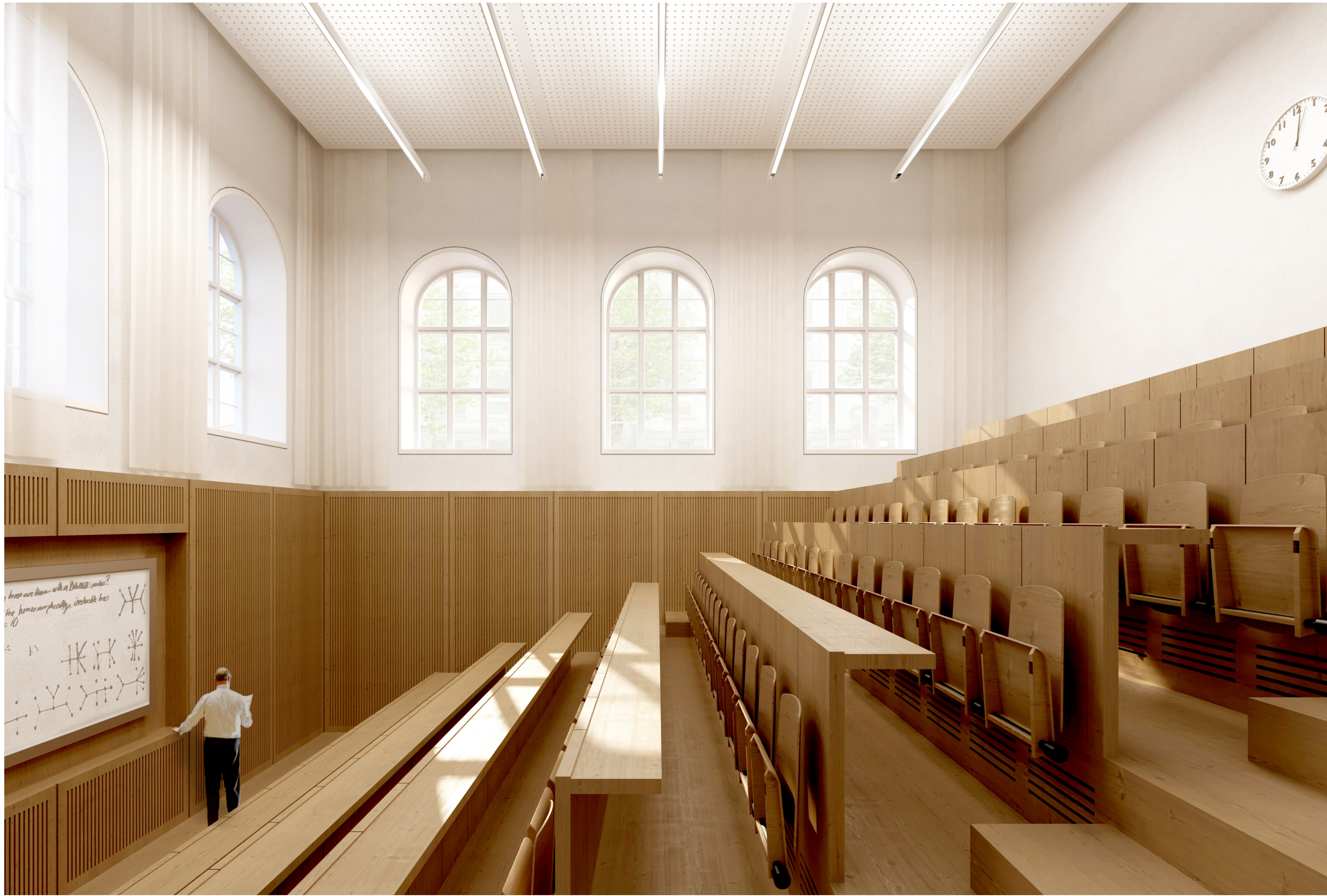
Abb. 3 | Neuer Hörsaal | Durch den Abbruch der Decke zwischen Untergeschoss und Erdgeschoss fügt sich das Hörsaalgestühl ein und stellt die denkmalgeschützte Fassade frei.
