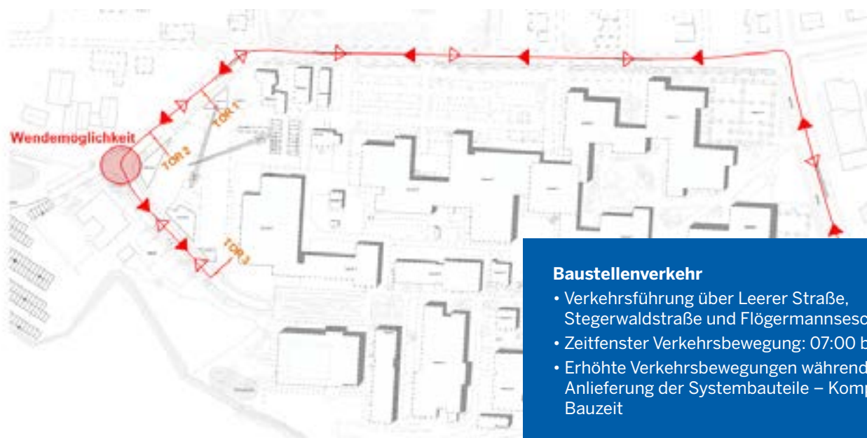
Baustellenlogistik während der 1. Ausbaustufe für Parkhaus und Ersatzneubau C und Q.
